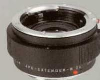
**LEICA APO-EXTENDER-R 1,4 x** Cet additif optique très maniable prolonge la focale de l'objectif accouplé de 1,4 x. La distance minimum de mise au point des objectifs n'est pas modifiée. L'ouverture se réduit seulement d'un diaphragme. La retransmission du diaphragme automatique est assurée. Certains objectifs ne sont pas adaptables au LEICA APO-EXTENDER-R 1,4 x (renseignements sur demande).
