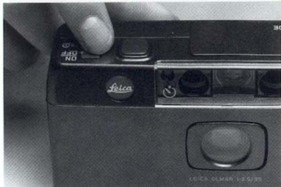
Si le mouvement de sortie de l'objectif est gêné mécaniquement, par exemple dans le sac ou quand on photographie à travers une fenêtre et que la vitre repousse l'objectif dans le boîtier de l'appareil, il ne s'ensuivra en règle générale aucun dommage pour le mécanisme. Une mise au point optimale ne sera toutefois pas possible sous ces conditions.
