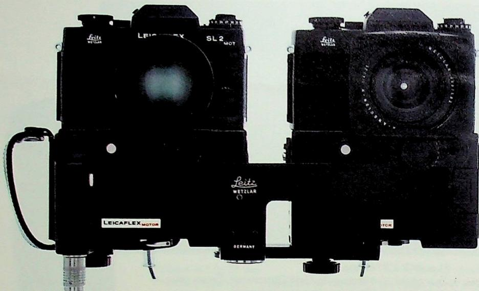
Un moteur électrique s'adapte sur ce modèle spécial, permettant une cadence de prises de vue de 4 images/seconde. Ce moteur est alimenté par 10 piles de 1.5 volts ou par accus rechargeables. Le Leicaflex SL 2 MOT peut être complété par des dispositifs spéciaux comme les commandes à distance par fil ou radio, et surtout par le dispositif tandem. Sa cadence atteint alors 7 à 8 photos à la seconde.
