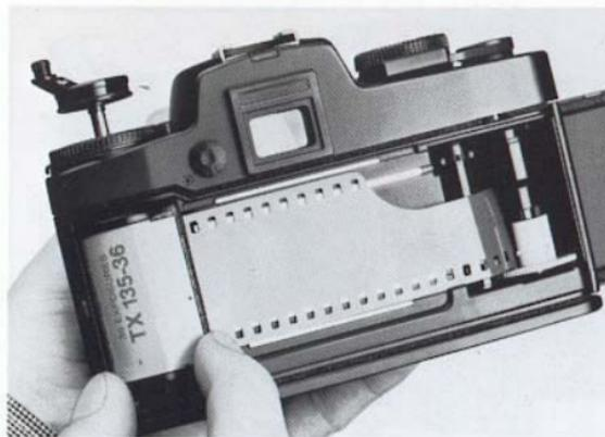
Refermer le boîtier en appuyant sur le dos pour le verrouiller. Déclencher l'appareil. Armer à nouveau et déclencher. Réarmer. L'appareil est alors prêt pour prendre la première photo. Le compteur d'images (1) indique „1”. Ce compteur peut aller jusqu'à „36”. Les chiffres „20”, „24” et „36”, correspondant aux différentes longueurs des films, sont gravés en rouge.
