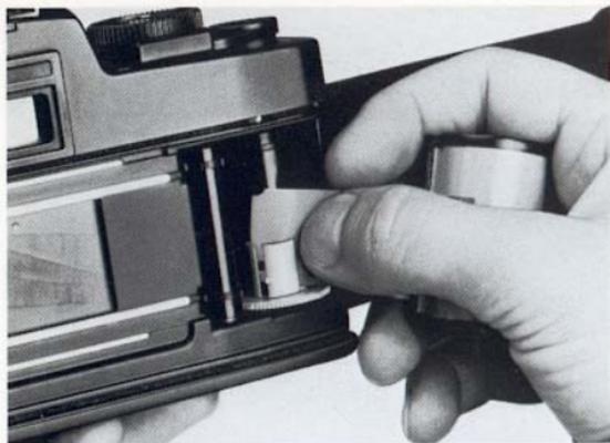
Saisir la cartouche comme le montre la figure, la couche sensible dirigée vers soi. Introduire l'amorce du film obliquement, à partir du haut, dans une des fentes de la bobine réceptrice; il faut que l'amorce soit prise complètement par une des languettes et s'engage un peu **sous** la languette voisine.
