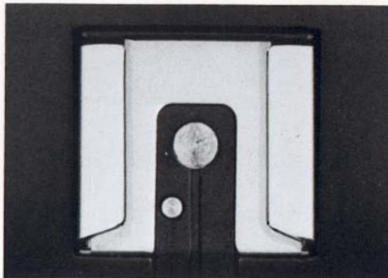
Le clignotement de la diode triangulaire à droite et en haut du viseur signifie que le flash est prêt à fonctionner. Si le flash n'est pas prêt ou s'il est à l'arrêt, le LEICA R4s MOD. 2 revient automatiquement au programme sélectionné.
