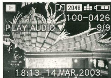
Pour lire l'enregistrement audio, appuyez sur le bord inférieur du bouton directionnel.
