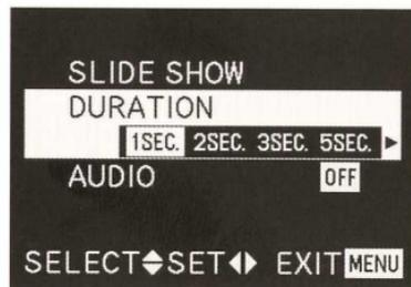
6. Appuyez sur le bord gauche et/ou droit du bouton directionnel pour sélectionner la période d'arrêt souhaitée, **1 SEC, 2 SEC, 3 SEC, 5 SEC**.
