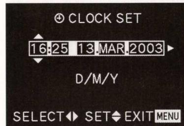
3. Réglez les chiffres en appuyant sur le bord supérieur ou inférieur du bouton directionnel. Appuyer sur le bord supérieur augmente le chiffre, appuyer sur le bord inférieur le diminue. Vous pouvez sélectionner la valeur numérique suivante ou le mois en appuyant sur le bord gauche ou droit du bouton directionnel et effectuer le réglage de la même manière. La valeur/le mois réglé est enregistré lorsque vous sélectionnez la valeur suivante/le mois.
