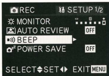
Les flèches noires qui s'affichent à gauche et/ou à droite des variantes de fonction indiquent les bords du bouton directionnel sur lesquels vous devez appuyer pour sélectionner d'autres réglages.
