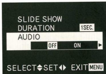
8. Appuyez sur le bord gauche et/ou droit du bouton directionnel pour sélectionner la fonction souhaitée, avec ou sans reproduction audio.
