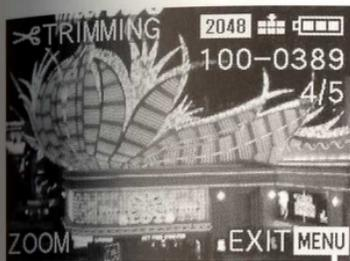
6. Sélectionnez la taille de rognage souhaitée à l'aide du levier de zoom (1. 23). Si vous appuyez sur le côté droit (téléobjectif), le rognage est plus petit et la vue plus grande, si vous appuyez sur le côté gauche (grand angle), le rognage est plus grand et la vue plus petite. Quatre niveaux d'agrandissement sont disponibles.
