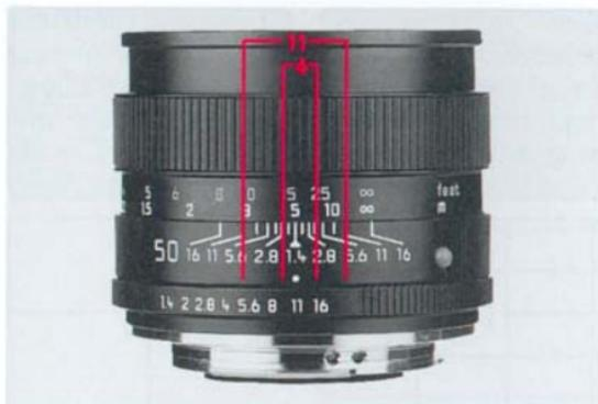
L'échelle de profondeur de champ, gravée sur les objectifs, indique l'étendue de la profondeur de champ pour chaque distance mise au point. Pour citer un exemple: avec l'objectif SUMMICRON-R 1:2/50 mm réglé sur 5 m, la profondeur de champ au diaphragme 4 s'étend de 4 m à 8 m, au diaphragme 11 d'environ 3 m à 20 m. Pour de plus amples informations sur la profondeur de champ, consulter notre table de profondeur de champ N°. 920 003.
