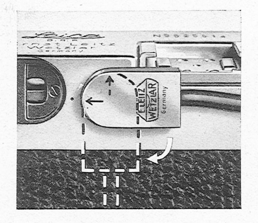
La fiche est placée sur la prise de courant du LEICA en position horizontale, c'est-à-dire que la flèche gravée doit être tournée vers les oeilletons jumelés. La fiche étant introduite, la tourner vers le bas de façon que la flèche soit dirigée vers le haut, ce qui immobilise la fiche dans la prise.
