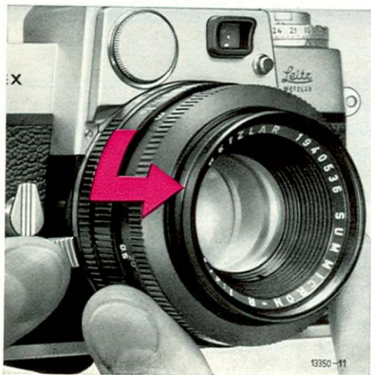
**Montage de l'objectif:** Le repère rouge (20) de la monture d'objectif doit être placé en face du point rouge marqué sur le boîtier de l'appareil; il suffit de tourner l'objectif vers la droite jusqu'à son enclenchement audible.
