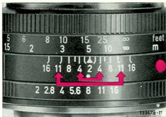
L'échelle graduée de profondeur de champ indique la zone de netteté en profondeur en fonction de la distance du sujet et de l'ouverture du diaphragme. Si vous avez réglé, par exemple, le SUMMICRON-R 50 mm sur 5 m, la netteté s'étendra entre 4 et 8 m au diaphragme 4, tandis qu'elle serait comprise entre 3 m et 20 m au diaphragme 11.
