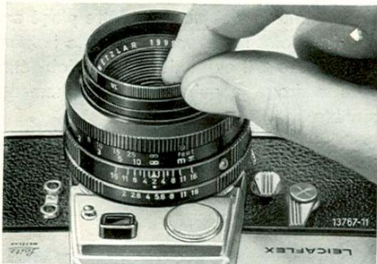
Tous les objectifs du LEICAFLEX sont prévus pour recevoir des filtres cerclés normalisés, maintenus au moyen d'une bague à vis (Retainer) (b).
