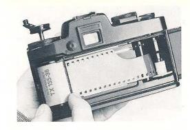
Refermer le boîtier en appuyant sur le dos pour le verrouiller. Déclencher l'appareil. Armer à nouveau et déclencher. Réarmer. L'appareil est alors prêt pour prendre la première photo. Le compteur d'images (1) indique "1". Ce compteur peut aller jusqu'à "36". Les chiffres "20", "24" et "36", correspondant aux différentes longueurs des films, sont gravés en rouge.
