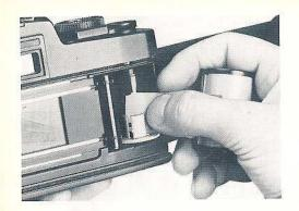
Saisir la cartouche comme le montre la figure, la couche sensible dirigée vers soi. Introduire l'amorce du film obliquement, à partir du haut, dans une des fentes de la bobine réceptrice; il faut que l'amorce soit prise complètement par une des languettes et s'engage un peu sous la languette voisine.
