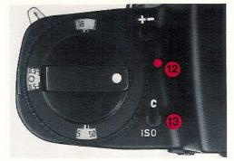
Avant de commencer à photographier, en particulier quand l'appareil n'a pas été utilisé depuis un certain temps, vérifier l'état des piles. Pour cela appuyer sur le bouton (13) pendant env. 5 secondes. La diode (12) placée devant le bouton s'allume en rouge si les piles sont bonnes. Si la luminosité de la diode diminue visiblement pendant ces 5 secondes, c'est que les piles sont près d'être usées. Il faut dans ce cas les remplacer aussitôt que possible.
