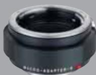
**LEICA MACRO-ADAPTER-R** Cette bague intermédiaire rallonge le tirage de 30 mm. La mesure de l'exposition à pleine ouverture et la commande automatique du diaphragme sont transmises. Il retransmet aussi les réglages en automatisme à priorité au diaphragme et le réglage manuel. **N° de code 14 299**
