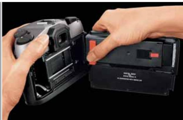
Le capteur est directement accessible après que l'on ait enlevé le couvercle et peut le cas échéant, être nettoyé simplement. Le capteur est suspendu et se positionne ainsi exactement sur le plan-image.
