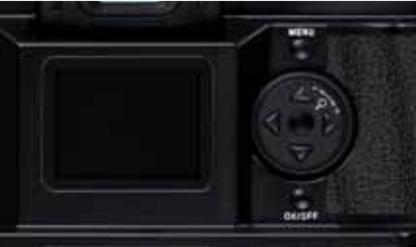
**Pad/Menu/OK/OFF** Le pad constitué de quatre petites touches disposées au point cardinaux permet de naviguer dans les menus, de sélectionner une image et d'en agrandir une portion. Les fonctions accessibles par ces menus concernent la configuration de base du LEICA DIGITAL-MODUL-R (profil utilisateur, gestion des couleurs, clarté et contraste de l'écran).
