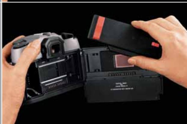
L'unité d'alimentation est la « centrale d'énergie » du système : un moteur prend en charge le réarmement de l'obturateur. Le boîtier et le LEICA DIGITAL-MODUL-R sont alimentés par des accus aux ions lithium.
