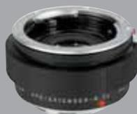
**LEICA APO-EXTENDER-R 2 x** Il double la focale des objectifs à partir de 50 mm et d'ouverture de 1:2 ou plus réduite. Accouplé avec des objectifs apochromatiques, leurs performances restent inchangées. Le LEICA APO-EXTENDER-R 2 x reporte le réglage et la fermeture du diaphragme et s'utilise en automatisme à priorité au diaphragme et en réglage manuel sans restriction. **N° de code 11 269**
