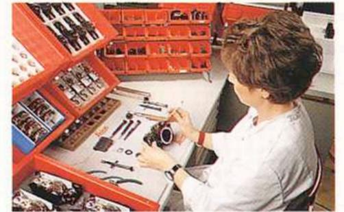
Le montage final du LEICA R 7 exige un maximum de savoir-faire et de précision mécanique.
