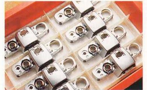
Capot très résistant, en zinc moulé sous pression, à chromage permanent, suivant un procédé spécialement développé par Leica.
