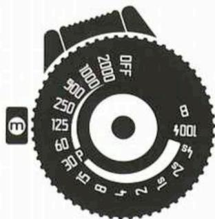
Pour une parfaite maîtrise des conditions d'éclairage difficiles: Réglage manuel avec mesure sélective de l'exposition **m**.
