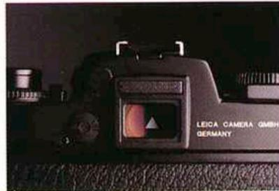
Le volet d'occultation de l'oculaire empêche la lumière parasite de perturber l'action du posemètre, notamment lors de prises de vue sur trépied.
