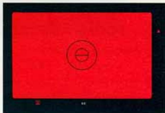
Représentation schématique de la mesure TTL au flash Leitz
