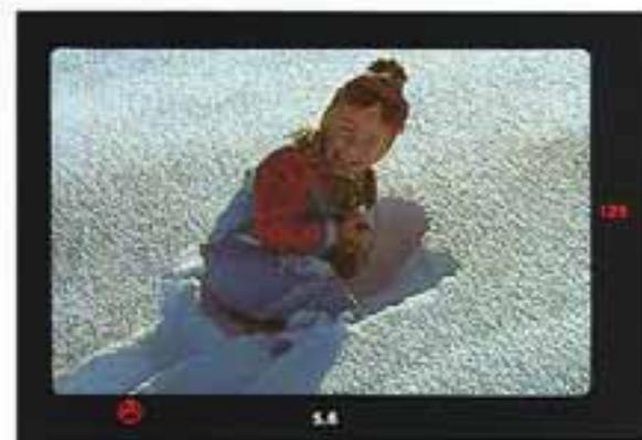
l'image doit être mesurée avec précision et sa profondeur de champ accentuée. Par exemple, dans les portraits. Dans ce cas, après avoir commuté sur le programme **A** et procédé au réglage manuel du diaphragme le plus adéquat, le LEICA R 5 déterminera automatiquement le temps d'exposition. Pour ce programme, la mesure sélective de l'exposition est symbolisée par le cercle.
