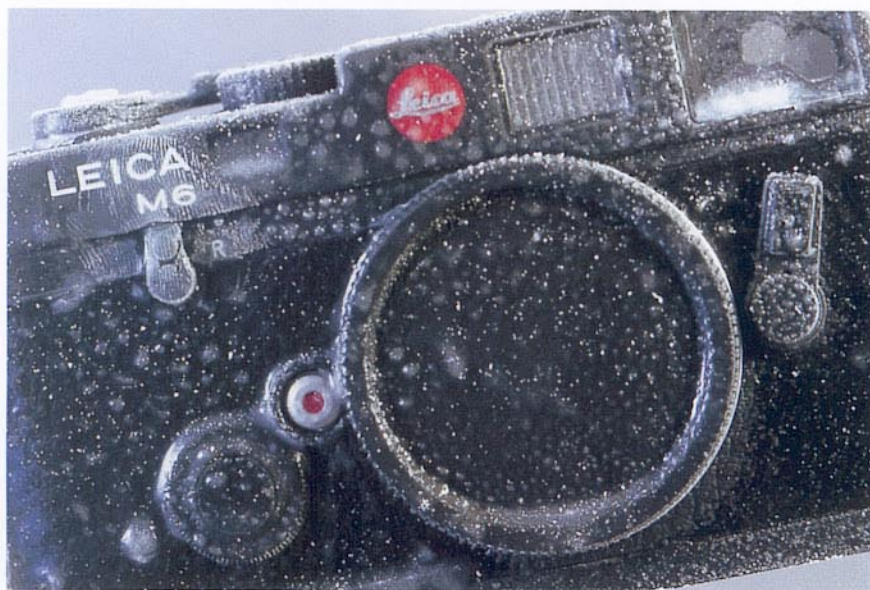
Chaque appareil est soumis à de rudes tests climatiques, en plusieurs cycles, de -25° à +60°C.
